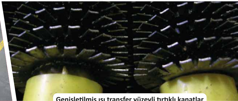
Genişletilmiş ısı transfer yüzeyli tırtıklı kanatlar
